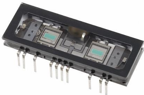
(資料 32:6P1:Web:SWITCH SCIENCE ) このモジュール形状から一瞥しただけでは何もわからない。これが真空管と言えば、更に混乱するだろう。2015年に(株)リタケカンパニーリミテドと(株)コルグにより共同開発された未来型真空管で NUTUBE と呼ばれるものだ。この真空管は 6P1 と命名された。
