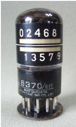
資料 18: 静電型計数管 6370/E1T 松下電子工業(株) 我が国の唯一の静電型 計数管を生産した。
