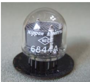
資料 20:数字表示管(ニキシー管) 6844A 日本電気(株) 6844A はパロース社が 6844 を改良したもの。
