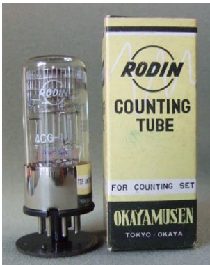
資料 19:デカトロン(冷陰極放電管) 4CG-10A(DK23) 岡谷電機(株) 岡谷の計数放電管は DK23,DK24,DK25,DK26 を生産した
