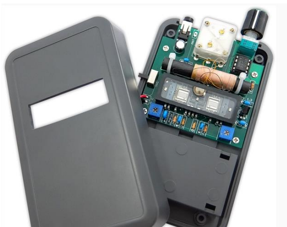
(資料 33:6P1 ラジオ:Web:Hamlife.JP ) 2017年には電波新聞社から 6P1 採用のラジオキットが限定販売された。6P1 の 1 本で検波と低周波増幅を受け持たせている。これが往年の真空管ファンから指示を得られたかどうかは定かではない。しかし、真空管の新しいカタチを具現化したことには注目しなす。将来、電力増幅用の NUTUBE が開発されたならば、一体どのような世界が見えてくるのだろうか。
