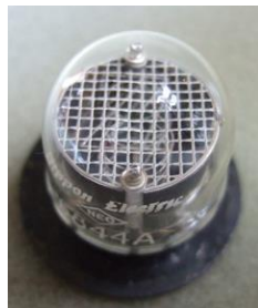
資料 20:数字表示管(ニキシー管) 6844A 日本電気(株) 6844A はパロース社が 6844 を改良したもの。
