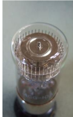
資料 19:デカトロン(冷陰極放電管) 4CG-10A(DK23) 岡谷電機(株) 岡谷の計数放電管は DK23,DK24,DK25,DK26 を生産した
